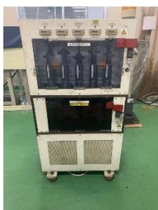
図6 薄板疲労試験機
