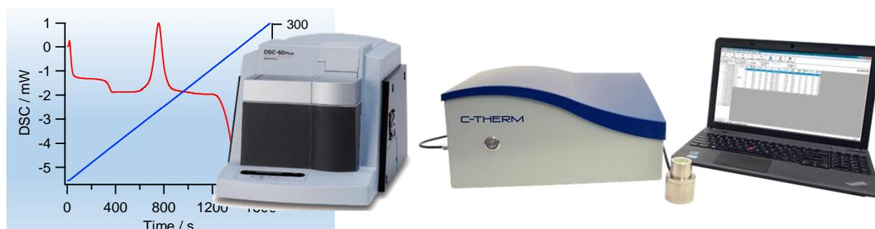
示差走査熱量計(左)と熱伝導率測定装置(右)
