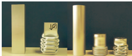
アルミ管の落錘衝撃試験の例
