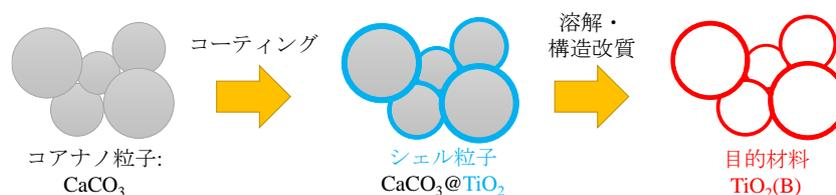
図 1 中空球状  $\text{TiO}_2(\text{B})$  の合成
