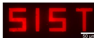
図 1. In-situ 合成により形成した CdSe QDs のマイクロパターンの蛍光顕微鏡像
