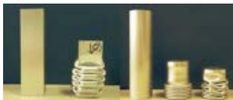
アルミ管の落錘衝撃試験の例
