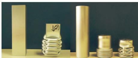
アルミ管の落錘衝撃試験の例
