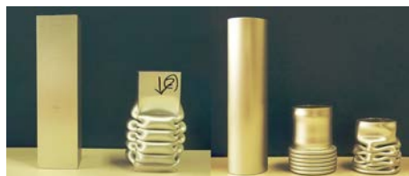
アルミ管の落錘衝撃試験の例
