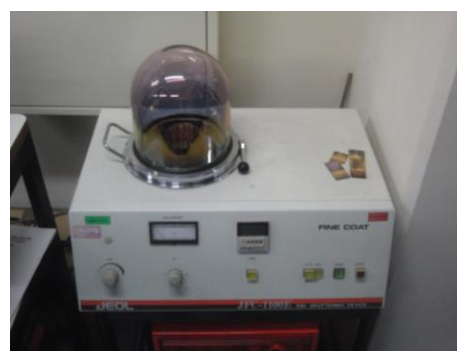
図1 イオンスパッタリング装置
