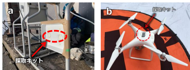
図 1 サンプリングキットの設置状況 (a 富士山頂, b ドローン)
