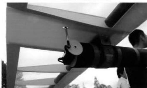
図-15 アクチュエーターによる昇降舵操作
