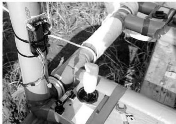
図-14 操縦桿装置
