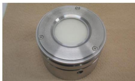
図 1 試料固定治具
