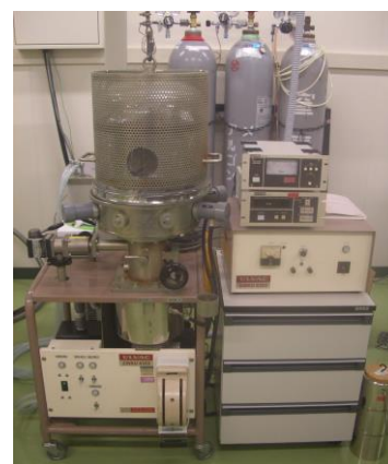
図 1 真空蒸着装置
