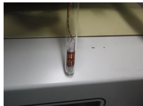
図 9 NMR 試料管中のプローブ
