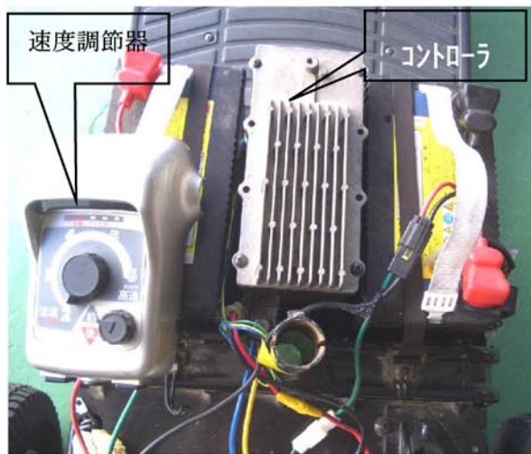
図7 車体に組み込んだコントローラ
