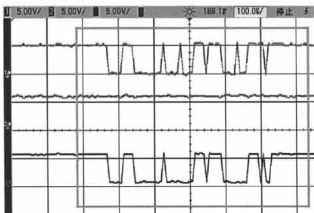
図 7.3.4 再送された波形 (上: 送信波形, 下: 受信波形)
