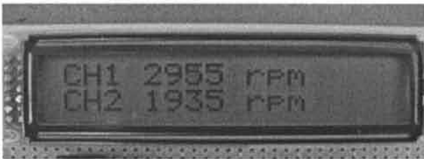
図6.1 フィルタ機能によるLCDへの表示
