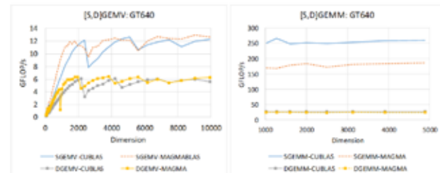
Fig. 6: GT640 の線型計算の性能評価 (左: 行列・ベクトル積, 右: 行列積)
