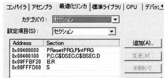
図5.3 RAM動作時のメモリ配置の例
