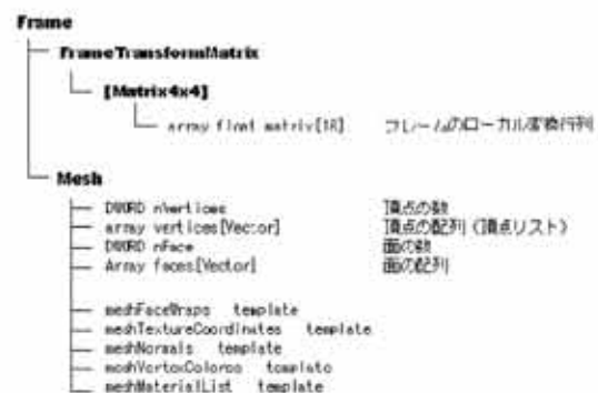
Fig. 8 フレーム構造体のメンバ構成[11]
